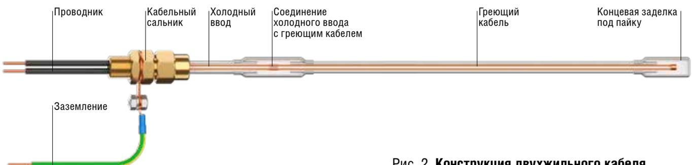
Рис. 2. Конструкция двухжильного кабеля
