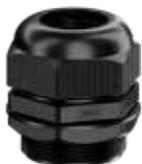
**Кабельный сальник М40** (Ех е) из полиамида для силовых кабелей диаметром от 17 до 28 мм.
