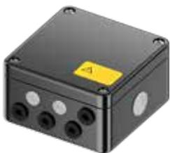
Соединительная коробка с 6 кабельными вводами M25 и 1 кабельным вводом M32, сертифицирована для применения во взрывоопасных зонах. Кабельный сальник M32 не входит в комплект и заказывается отдельно.
