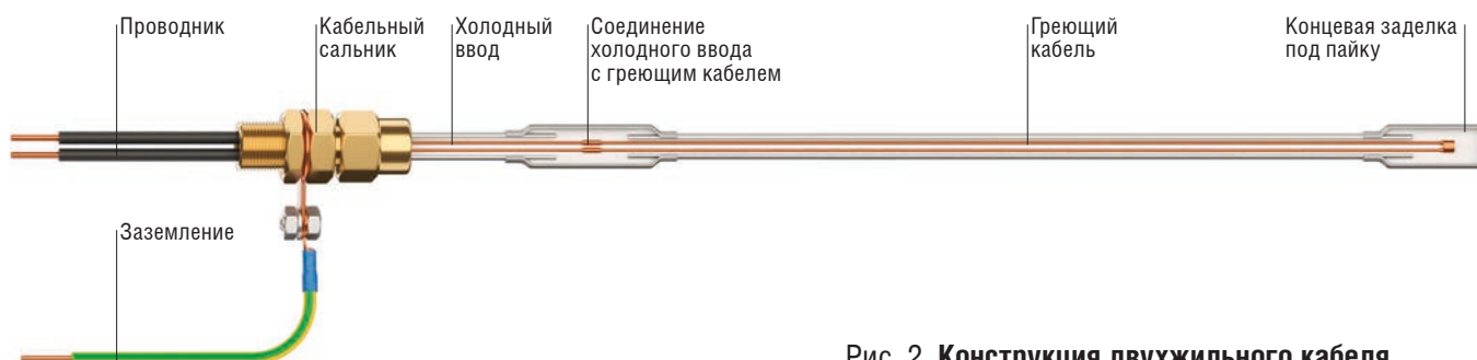
Рис. 2. Конструкция двухжильного кабеля
