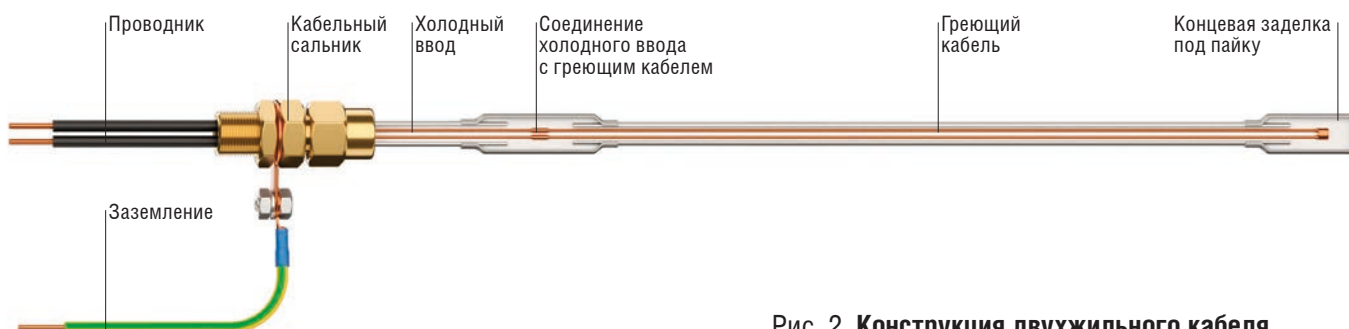
Рис. 2. Конструкция двухжильного кабеля
