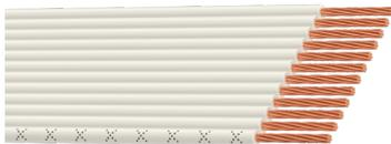
Провод установочный плоский. Кабель соответствует нормам пожаробезопасности ГОСТ Р МЭК 60332-1 и не распространяет пламя в случае пожара при одиночной прокладке. Расшифровка провода ПУВП: П - Провод У - Установочный В - С изоляцией из поливинилхлоридного пластика П - Плоский
