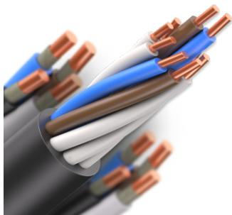
Кабель контрольный, с изоляцией и защитным шлангом из морозостойкого поливинилхлоридного пластика пониженной пожарной опасности, с броней из двух стальных оцинкованных лент, не распространяющий горение при групповой прокладке, с низким дымо- и газовыделением
