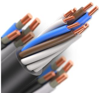
Кабель контрольный огнестойкий, с изоляцией и оболочкой из поливинилхлоридного пластика пониженной пожарной опасности в тропическом исполнении, не распространяющий горение при групповой прокладке, с низким дымо- и газовыделением, в общем экране
