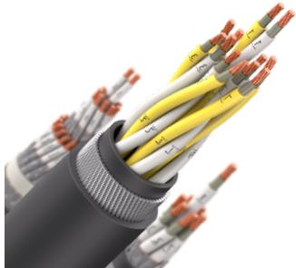
Кабель монтажный в холодостойком исполнении, с изоляцией и оболочкой из морозостойкого поливинилхлоридного пластика пониженной пожарной опасности, не распространяющий горение при групповой прокладке, с низким дымо- и газовыделением, герметизированный водоблокирующими элементами
