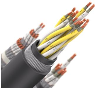
Кабель монтажный, с изоляцией из поливинилхлоридного пластика и оболочкой из поливинилхлоридного пластика пониженной горючести, не распространяющий горение при групповой прокладке, с индивидуальным экраном в виде оплетки из медных луженых проволок и с броней в виде повива из стальных оцинкованных проволок, герметизированный водоблокирующими элементами
