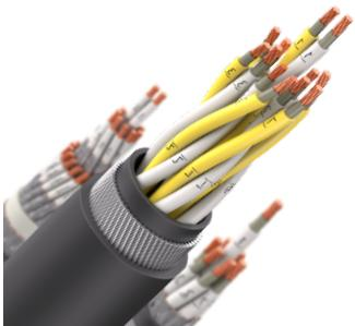
Кабель монтажный, с изоляцией из поливинилхлоридного пластика и оболочкой из поливинилхлоридного пластика пониженной горючести, не распространяющий горение при групповой прокладке, в общем экране в виде обмотки из алюмополимерной ленты с дренажным проводником и с броней в виде оплетки из стальных оцинкованных проволок
