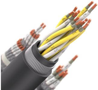
Кабель монтажный, с изоляцией и оболочкой из поливинилхлоридного пластика пониженной пожарной опасности, не распространяющий горение при групповой прокладке, с низким дымо- и газовыделением, в общем комбинированном экране в виде обмотки из алюмополимерной ленты и оплетки из медных луженых проволок, герметизированный водоблокирующими элементами
