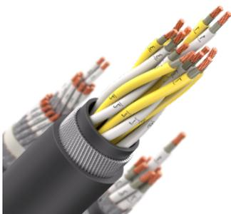
Кабель монтажный, с изоляцией и оболочкой из поливинилхлоридного пластика пониженной пожарной опасности, не распространяющий горение при групповой прокладке, с низким дымо- и газовыделением, с индивидуальным экраном в виде оплетки из медных проволок, в общем экране в виде обмотки из алюмополимерной ленты с дренажным проводником и с броней в виде обмотки из двух
