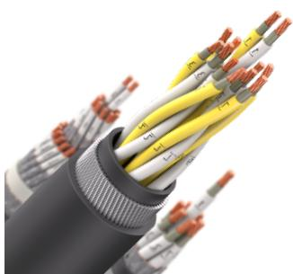
Кабель монтажный в холодостойком исполнении, с изоляцией и оболочкой из морозостойкого поливинилхлоридного пластика пониженной пожарной опасности, не распространяющий горение при групповой прокладке, с низким дымо- и газовыделением, в общем экране в виде обмотки из алюмополимерной ленты с дренажным проводником и с броней в виде повива из стальных оцинкованных
