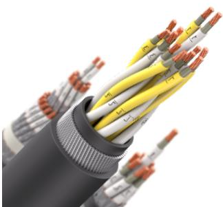
Кабель монтажный в холодостойком исполнении, с изоляцией и оболочкой из морозостойкого поливинилхлоридного пластика пониженной пожарной опасности, не распространяющий горение при групповой прокладке, с низким дымо- и газовыделением, в общем экране в виде оплетки из медных проволок
