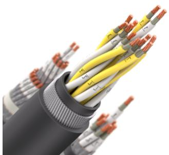
Кабель монтажный в холодостойком исполнении, с изоляцией и оболочкой из морозостойкого поливинилхлоридного пластика пониженной пожарной опасности, не распространяющий горение при групповой прокладке, с низким дымо- и газовыделением, с индивидуальным экраном в виде оплетки из медных луженых проволок, с броней в виде повива из стальных оцинкованных проволок,
