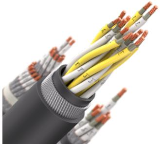
Кабель монтажный огнестойкий, с изоляцией и оболочкой из поливинилхлоридного пластика пониженной пожарной опасности, не распространяющий горение при групповой прокладке, с низким дымо- и газовыделением, с броней в виде оплетки из стальных оцинкованных проволок
