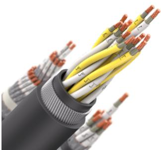
Кабель монтажный огнестойкий, с изоляцией и оболочкой из поливинилхлоридного пластика пониженной пожарной опасности, не распространяющий горение при групповой прокладке, с низким дымо- и газовыделением, в общем экране в виде обмотки из алюмополимерной ленты с дренажным проводником
