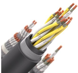
Кабель монтажный огнестойкий в холодостойком исполнении, с изоляцией и оболочкой из морозостойкого поливинилхлоридного пластика с пониженной пожарной опасности, не распространяющий горение при групповой прокладке, с низким дымо- и газовыделением, в общем экране в виде оплетки из медных проволок и с броней в виде повива из стальных оцинкованных проволок,
