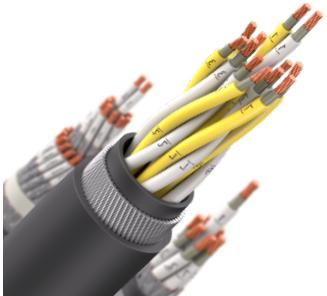
Кабель монтажный огнестойкий, с изоляцией и оболочкой из полимерной композиции, не содержащей галогенов, не распространяющий горение при групповой прокладке и не выделяющий коррозионно-активных газообразных продуктов при горении и тлении, с броней в виде повива из стальных оцинкованных проволок
