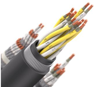
Кабель монтажный огнестойкий в холодостойком исполнении, с изоляцией из свитого полиэтилена и оболочкой из морозостойкого поливинилхлоридного пластика пониженной пожарной опасности, не распространяющий горение при групповой прокладке, с низким дымо- и газовыделением, в общем экране в виде обмотки из алюмополимерной ленты с дренажным проводником
