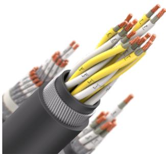
Кабель монтажный, с изоляцией из сшитого полиэтилена и оболочкой из маслобензостойкой полимерной композиции, не содержащей галогенов, не распространяющий горение при групповой прокладке и не выделяющий коррозионно-активных газообразных продуктов при горении и тлении, в общем экране в виде обмотки из алюмополимерной ленты с дренажным проводником и с броней в виде оплетки из стальных
