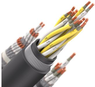
Кабель монтажный, с изоляцией и оболочкой из поливинилхлоридного пластика пониженной пожарной опасности, не распространяющий горение при групповой прокладке, с низким дымо- и газовыделением, герметизированный водоблокирующими элементами
