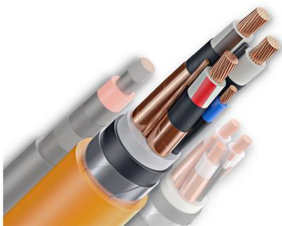
Изоляция из этиленпропиленовой резины, наружная оболочка из поливинилхлоридного пластика пониженной пожарной опасности, броня из стальных оцинкованных проволок в виде повива.
