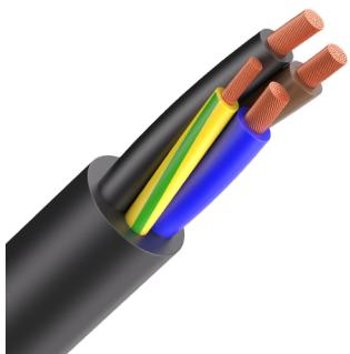
Кабель силовой гибкий, с медными жилами, с изоляцией и наружной оболочкой из термопластичных эластомеров (термоэластопластов)
