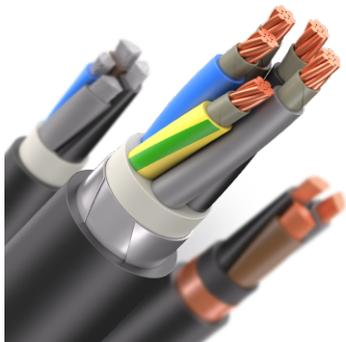
Кабели силовые с алюминиевыми жилами, с изоляцией из сшитого полиэтилена, с броней в виде повива из стальных оцинкованных проволок и защитным шлангом из поливинилхлоридного пластика пониженной горючести, не распространяющие горение при групповой прокладке
