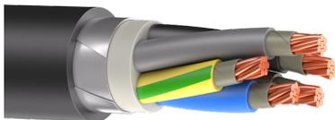
Силовой бронированный кабель с медной жилой, с изоляцией и оболочкой из полимерных композиций, не содержащих галогенов пониженной пожарной опасности. Предназначен для передачи и распределения электрической энергии в стационарных установках на номинальное переменное напряжение 0,66; 1 кВ частоты 50 Гц.
