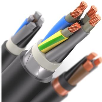
Кабели силовые с алюминиевыми жилами, с изоляцией из свитого полиэтилена, с броней в виде повива из стальных оцинкованных проволок и защитным шлангом из полиэтилена
