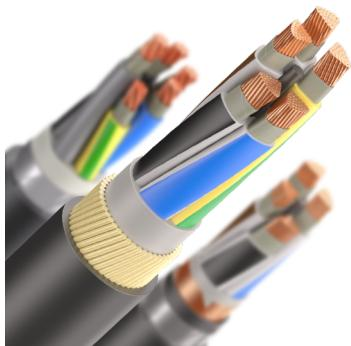
Кабели контрольные торговой марки "КЭУ" с медными или медными лужеными жилами, с изоляцией и наружной оболочкой из поливинилхлоридного пластика пониженной пожарной опасности, не распространяющие горение при групповой прокладке по категории А, с пониженным дымо- и газовыделением, в общем экране в виде оплетки из медных проволок
