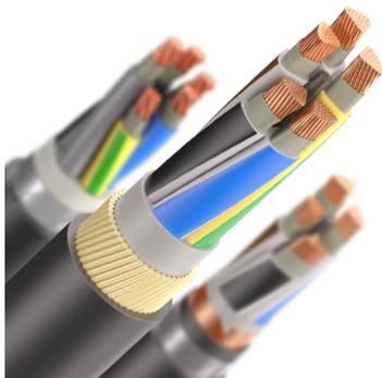
Кабели контрольные огнестойкие торговой марки "КЭУ" с медными или медными лужеными жилами, с термическим барьером в виде обмотки из двух слюдосодержащих лент поверх токопроводящих жил, с изоляцией из поливинилхлоридного пластиката пониженной пожарной опасности, в общем экране в виде обмотки из медной ленты, с броней в виде обмотки из двух стальных оцинкованных лент и защитным
