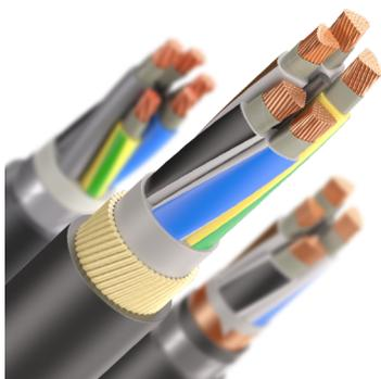
Кабели контрольные торговой марки "КЭУ" с медными или медными лужеными жилами, с изоляцией и наружной оболочкой из поливинилхлоридного пластика пониженной пожарной опасности, не распространяющие горение при групповой прокладке по категории А, с пониженным дымо- и газовыделением
