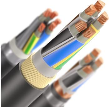
Кабели контрольные огнестойкие торговой марки "КЭУ" с медными или медными лужеными жилами, с термическим барьером в виде обмотки из двух слюдосодержащих лент поверх токопроводящих жил, с изоляцией из поливинилхлоридного пластика пониженной пожарной опасности, с броней в виде обмотки из двух стальных оцинкованных лент и защитным шлангом из поливинилхлоридного
