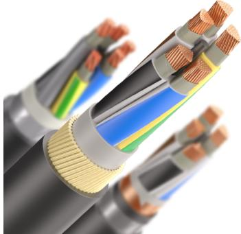
Кабели контрольные торговой марки "КЭУ" с медными или медными лужеными жилами, с изоляцией из поливинилхлоридного пластика пониженной пожарной опасности, с броней в виде обмотки из двух стальных оцинкованных лент и защитным шлангом из поливинилхлоридного пластика пониженной пожарной опасности, не распространяющие горение при групповой прокладке по категории А, с пониженным дымо- и газовыделением
