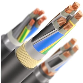
Кабели контрольные торговой марки "КЭУ" в холодостойком исполнении, с медными или медными лужеными жилами, с изоляцией из сшитого полиэтилена, с броней в виде повива из круглых стальных оцинкованных проволок и защитным шлангом из морозостойкой полимерной композиции, не содержащей галогенов, не распространяющие горение при групповой прокладке по категории А и не
