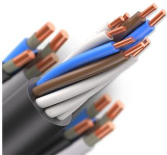
Кабель контрольный, с изоляцией и защитным шлангом из поливинилхлоридного пластика пониженной пожарной опасности, с броней из стальных оцинкованных проволок, не распространяющий горение при групповой прокладке, с низким дымо- и газовыделением
