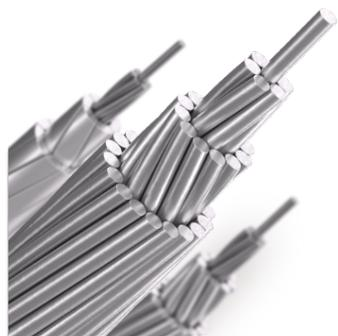
Провод, состоящий из стального сердечника, выполненного из стальных оцинкованных проволок нормальной прочности, и ТПЧ из алюминиевых проволок, межпроволочное пространство стального сердечника, включая его наружную поверхность, заполнено нейтральной смазкой повышенной нагревостойкости.
