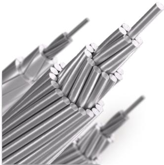
Провод, состоящий из стального сердечника, выполненного из стальных оцинкованных проволок нормальной прочности, и ТПЧ из алюминиевых проволок, межпроволочное пространство всего провода заполнено нейтральной смазкой повышенной нагревостойкости
