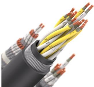
Кабель монтажный, с изоляцией и оболочкой из поливинилхлоридного пластика, с броней в виде обмотки из двух стальных оцинкованных лент
