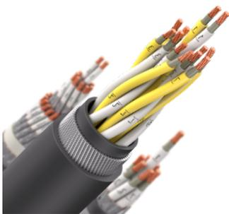
Кабель монтажный в холодостойком исполнении, стойкий к воздействию солнечного излучения, с изоляцией из морозостойкого поливинилхлоридного пластика и оболочкой из морозостойкого поливинилхлоридного пластика пониженной горючести, стойкого к воздействию ультрафиолетового излучения, не распространяющий горение при групповой прокладке, в общем экране в виде обмотки из
