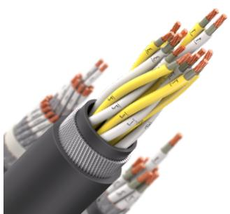
Кабель монтажный в холодостойком исполнении, стойкий к воздействию солнечного излучения, с изоляцией из морозостойкого поливинилхлоридного пластика и оболочкой из морозостойкого поливинилхлоридного пластика пониженной горючести, стойкого к воздействию ультрафиолетового излучения, не распространяющий горение при групповой прокладке, в общем экране в виде оплетки из
