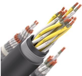
Кабель монтажный в холодостойком исполнении, с изоляцией из морозостойкого поливинилхлоридного пластика и оболочкой из морозостойкого поливинилхлоридного пластика пониженной горючести, не распространяющий горение при групповой прокладке, с индивидуальным экраном в виде оплетки из медных луженых проволок и с броней в виде повива из стальных оцинкованных проволок
