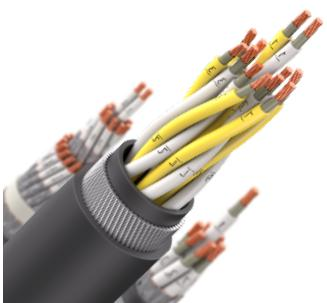
Кабель монтажный огнестойкий, с изоляцией и оболочкой из поливинилхлоридного пластика пониженной пожарной опасности, не распространяющий горение при групповой прокладке, с низким дымо- и газовыделением, в общем экране в виде оплетки из медных луженых проволок, с броней в виде обмотки из двух стальных оцинкованных лент
