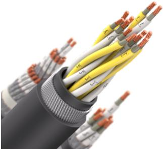
Кабель монтажный огнестойкий, с изоляцией и оболочкой из поливинилхлоридного пластика пониженной пожарной опасности, не распространяющий горение при групповой прокладке, с низким дымо- и газовыделением, в общем экране в виде обмотки из алюмополимерной ленты с дренажным проводником и с броней в виде повива из стальных оцинкованных проволок
