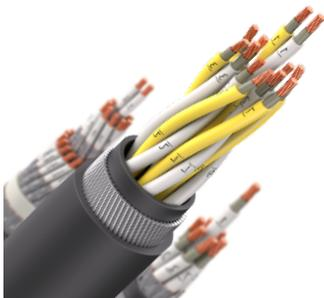
Кабель монтажный огнестойкий, с изоляцией и оболочкой из поливинилхлоридного пластика пониженной пожарной опасности, не распространяющий горение при групповой прокладке, с низким дымо- и газовыделением, с броней в виде обмотки из двух стальных оцинкованных лент
