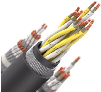
Кабель монтажный, с изоляцией и оболочкой из полимерной композиции, не содержащей галогенов, не распространяющий горение при групповой прокладке и не выделяющий коррозионно-активных газообразных продуктов при горении и тлении, в общем экране в виде оплетки из медных проволок и с броней в виде повива из стальных оцинкованных проволок
