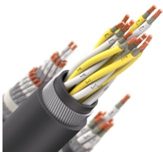
Кабель монтажный в холодостойком исполнении, с изоляцией из сшитого полиэтилена и оболочкой из морозостойкого поливинилхлоридного пластика с пониженной пожарной опасности, не распространяющий горение при групповой прокладке, с низким дымо- и газовыделением, в общем экране в виде обмотки из алюмополимерной ленты с дренажным проводником и с броней в виде повива из стальных оцинкованных проволок, герметизированный водоблокирующими элементами
