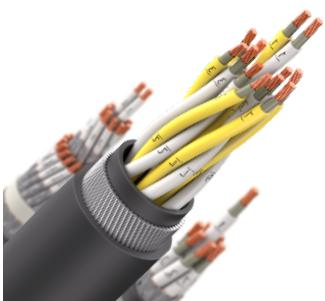
Кабель монтажный в холодостойком исполнении, с изоляцией из сшитого полиэтилена и оболочкой из морозостойкого поливинилхлоридного пластика с пониженной пожарной опасности, не распространяющий горение при групповой прокладке, с низким дымо- и газовыделением, в общем экране в виде оплетки из медных проволок, герметизированный водоблокирующими элементами
