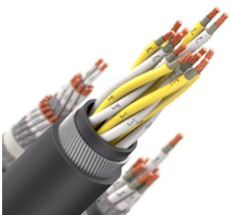
Кабель монтажный огнестойкий, с изоляцией из сшитого полиэтилена и оболочкой из поливинилхлоридного пластика пониженной пожарной опасности, не распространяющий горение при групповой прокладке, с низким дымо- и газовыделением, с индивидуальным экраном в виде оплетки из медных проволок и в общем экране в виде оплетки из медных проволок
