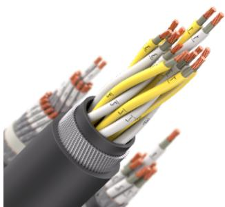
Кабель монтажный огнестойкий, с изоляцией из сшитого полиэтилена и оболочкой из полимерной композиции, не содержащей галогенов, не распространяющий горение при групповой прокладке и не выделяющий коррозионно-активных газообразных продуктов при горении и тлении, в общем экране в виде обмотки из алюмополимерной ленты с дренажным проводником и с броней в виде повива из стальных оцинкованных проволок
