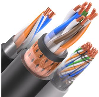
Кабель малогабаритный с медными жилами, с изоляцией из сшитого полиэтилена и оболочкой из поливинилхлоридного пластиката пониженной пожарной опасности, в общем экране под оболочкой в тропическом исполнении
