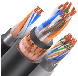
Кабель управления и контроля, огнестойкий, с медными жилами, с изоляцией и оболочкой из полимерных композиций, не содержащих галогенов, с общим экраном под оболочкой.
