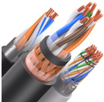
Кабель управления и контроля, огнестойкий, с медными жилами, с изоляцией и оболочкой из полимерных композиций, не содержащих галогенов, с индивидуальными экранами по изолированной жиле или паре изолированных жил.
